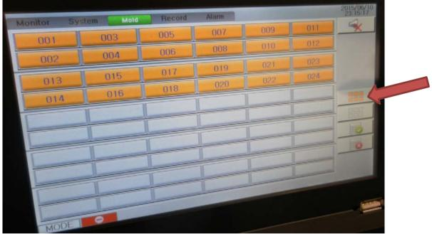
Una vez que haya completado este paso, debe tener todas sus zonas de boquilla (TIP) configuradas para el mismo perfil Siga los mismos pasos para establecer sus zonas de colector (M.F). Cuando miras la ventana principal, verás Que las boquillas se verán como boquillas y las zonas de colector se verán como colectores. Si tiene un casquillo de alimentación en su sistema, establezca esta zona como su última zona y establézcala como zona de boquilla.
